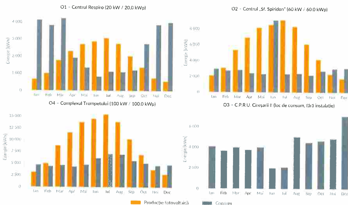
Figura 3 - Producția fotovoltaică și consumul de energie electrică, pe fiecare amplasament
